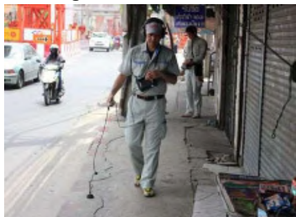
1. 漏水探知機を用いた漏水調査
