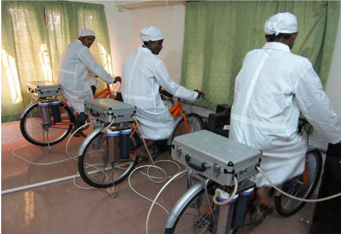
現地組立の自転車一体型浄水装置を使ったダッカ市内の水工場写真
