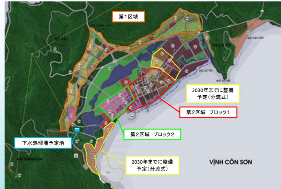
【図5: 中心地区下水道整備計画】 出典: 調査団作成
