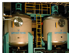
(民間) ソニー㈱多賀城工場 2200φ × 2基 純水装置前処理 (用水)
